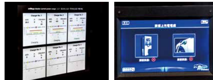
從 LMC 的顯示屏可以監察每個充電器的充電情況。有了 LMC 的管理，以後充電便不用煩排隊等充電的問題了。
